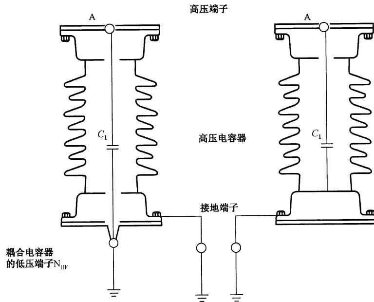
图 A.1 耦合电容器示例图(带低压端子和不带低压端子)
