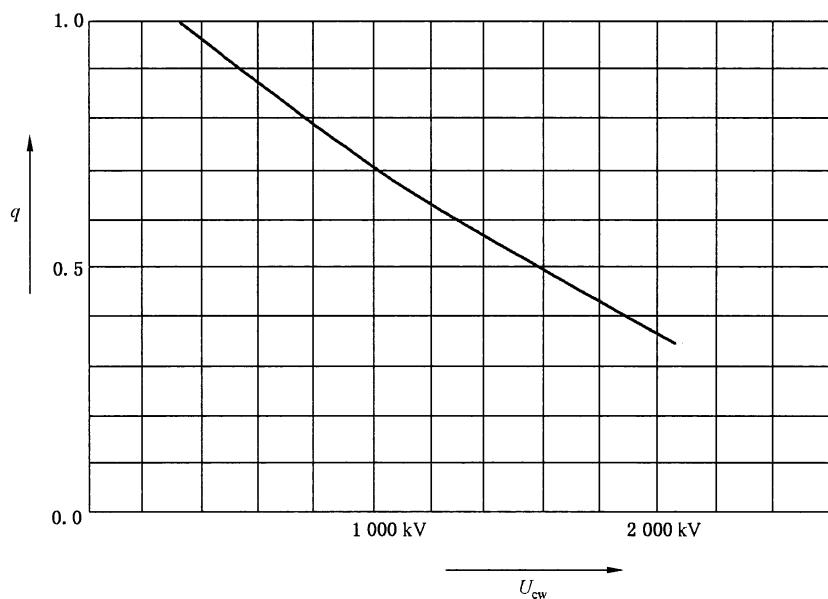
图 1 绝缘的海拔修正因数
